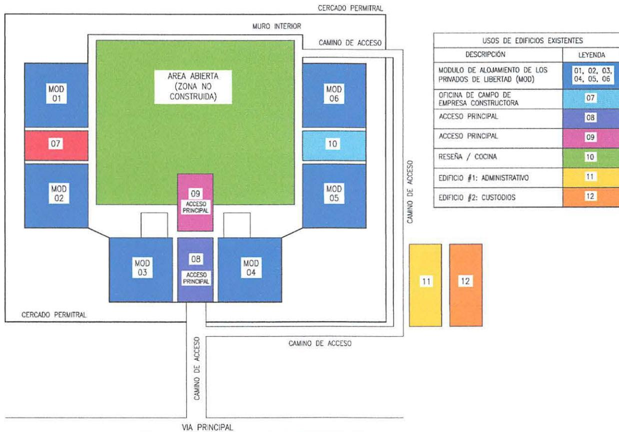
Figura 6. Edificios construidos y su distribución en el proyecto de Centro Penitenciario La Acequia.
